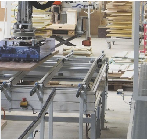
/ Das Portal übernimmt die definierte Drehung und Rückführung der Werkstücke zum Maschinenbediener.
