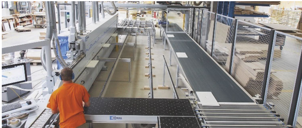
Flexibel und mit einer einzigen Steuerung unkompliziert zu bedienen: Die Kantenanleimmaschine Ambition 2482 ist in Kombination mit der Rückführung TFU 521 Edition besonders geeignet für Anwender, die eine große Teile- und Materialvielfalt bearbeiten – von der optischen Nullfuge bis hin zum Massivholzanleimer.
