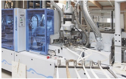
/ Qualität bei der Optik und Beanspruchbarkeit: Neben dem Airtec- ist ein PU-Schmelzklebeaggregat an Bord.
