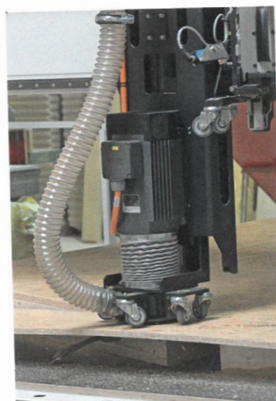
► Komplexer Platten-zuschnitt durch die Wallteq M-120 im Giebelbereich
