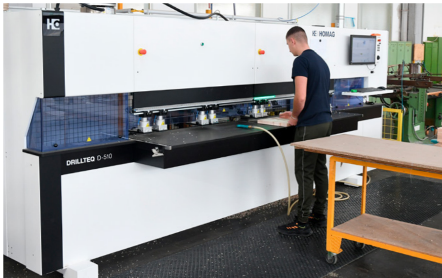
Bild: Eine Bohr- und Dübeleintreibmaschine „DRILLTEQ D-510“ stellt in Schwanenstadt die Folgebearbeitung sicher.
