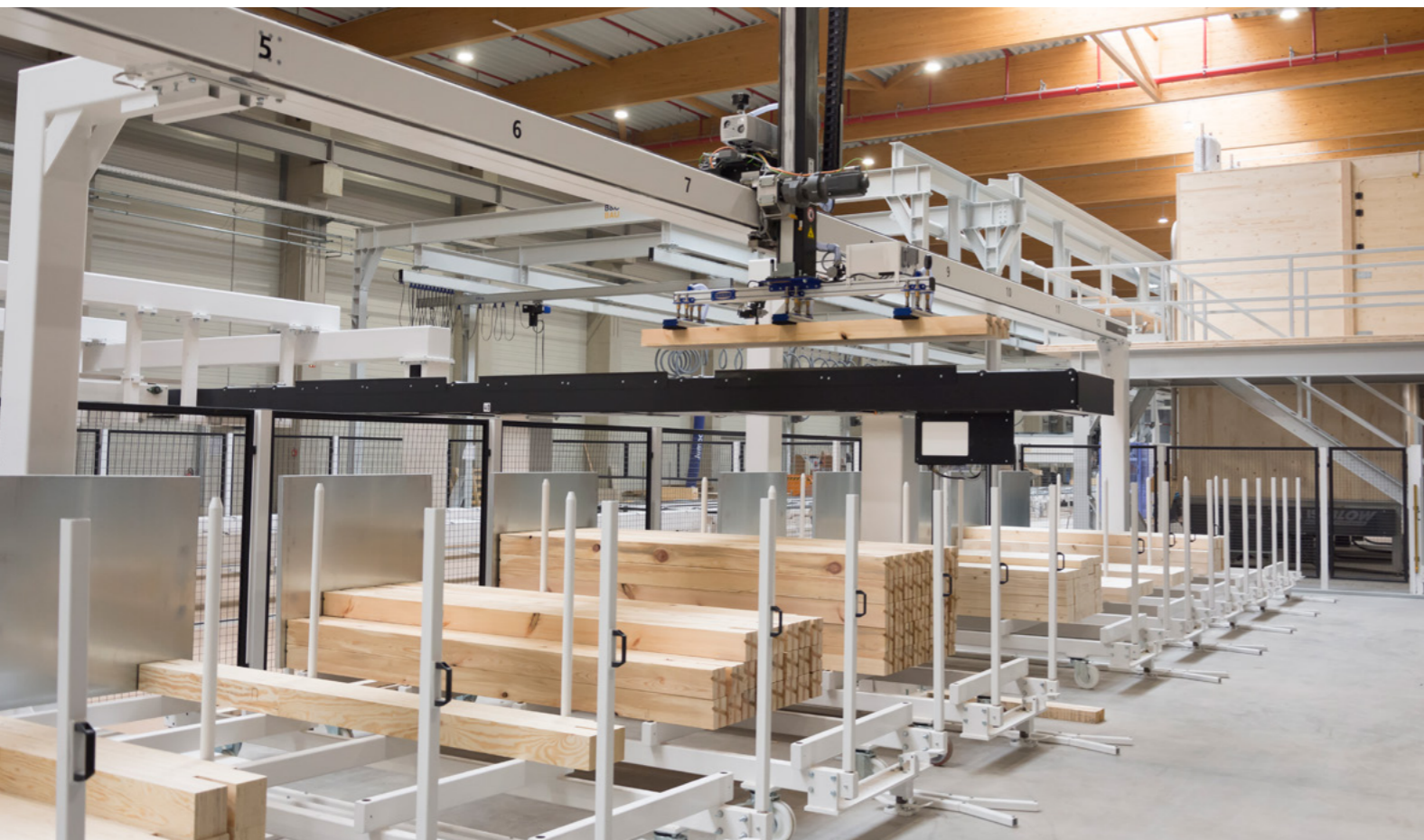
Bild Seite 18: Portal zur Zufuhr von Stielen an den Roboter der Riegelwerksstation.
