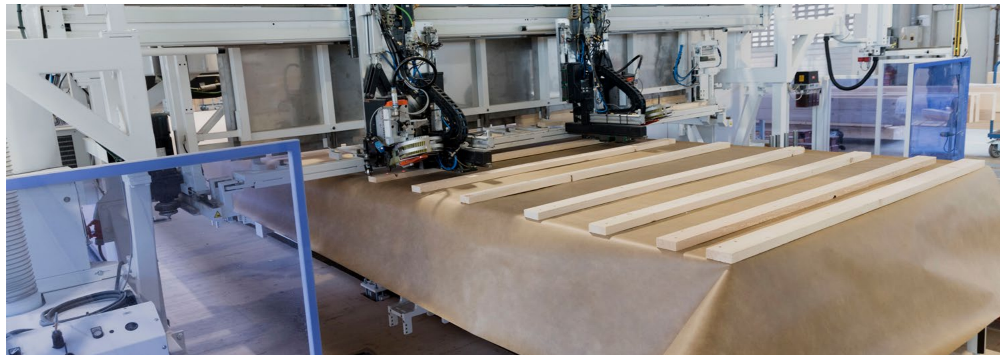
Fotografie: Na nové výrobní lince na střechy-stropy v Německu využívá firma zařízení WALLTEQ M-380 s funkcí kladení latí.
