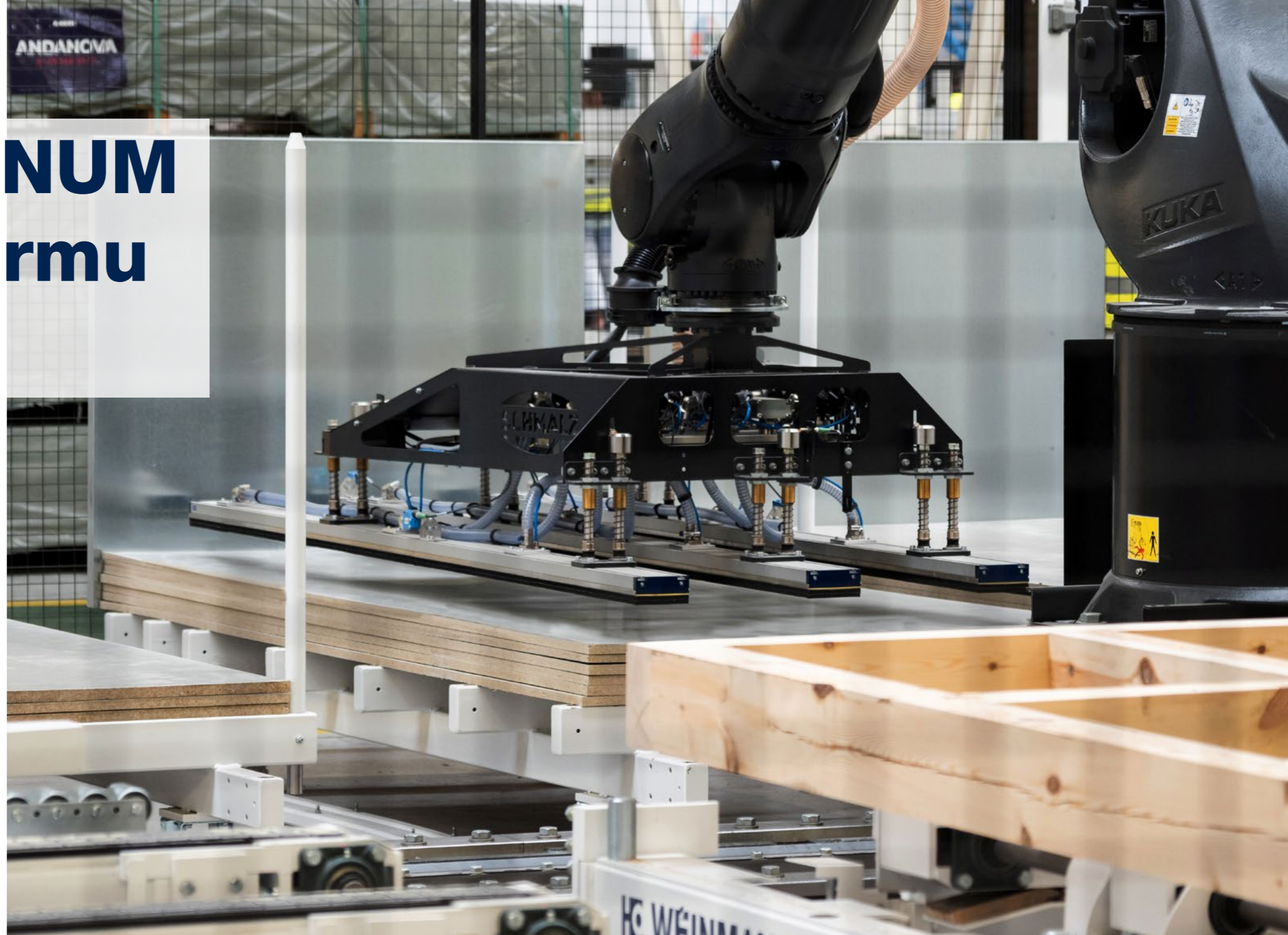
Fotografie: Vysoký stupeň automatizace ve výrobě společnosti LIGNUM TECH: Zařízení FEED-BOT W-500 automaticky pokládá desky na příčkovou konstrukci.
