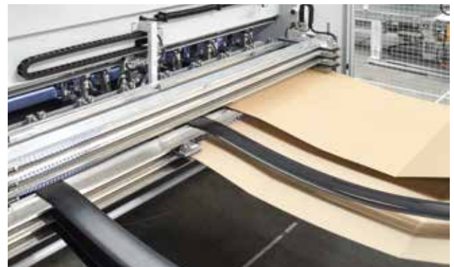
Der Endloskartonagenwechsler ist ein automatisches Wechselsystem für Endlosbahnbreiten mit bis zu sechs Fächern.
