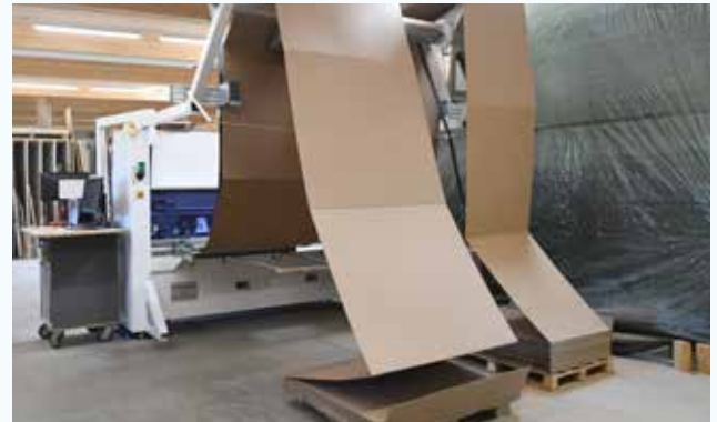
Bei Verwendung von Produktionslisten erfolgt die Kartonagenherstellung automatisiert. Unterbrechungen mit Einzelzuschnitten sind möglich, ohne dass die letzten Einstellungen „vergessen“ werden.
