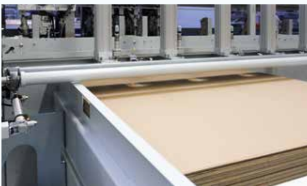
Die Einzelblattzuführung ermöglicht die Zuführung einzelner Verpackungsblätter sowie die Verwendung von Endloskartonage ohne Haspel.
