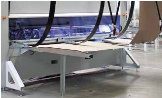
Die Kombi-Kartonagenzuführung ermöglicht die Zuführung von Einzelblättern sowie die Verwendung von Endloskartonagen.
