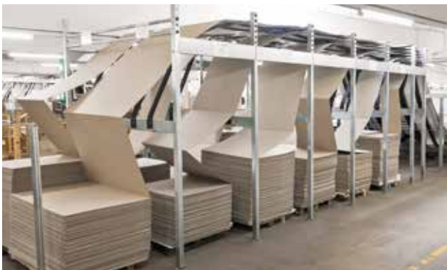
In der Betriebsart Side-by-Side wird das Kartonagenzuführfach um eine weitere Bahnbreite erweitert, sodass bei einem 6-Fach-Wechselsystem bis zu 12 Bahnbreiten im Einzelzugriff möglich sind.
