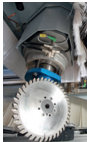
C-Achse (0-360°) für den Einsatz von Aggregaten
