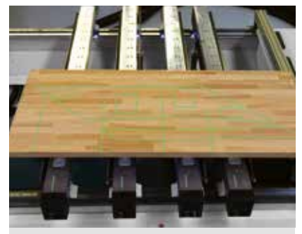
Projection laser des dispositifs de serrage et du contour de la pièce pour une utilisation optimale et une pose simple des pièces brutes qui ne peuvent pas être alignées contre les butées.
