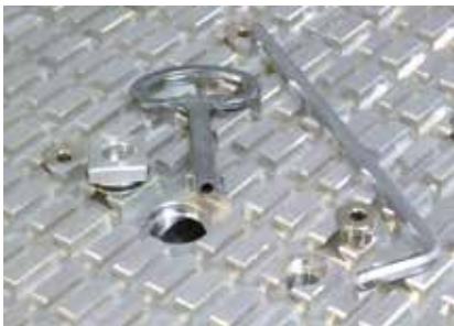
Raccords de vide 1" à ouverture rapide à l'aide de la clé de l'armoire de commande, ouvertures de vide avec filetage fin pour la fixation des éléments de serrage.
