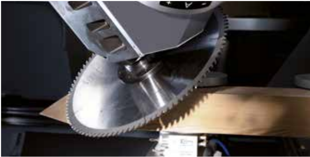
Coupe en biais avec grande profondeur de coupe pour éléments de cadre
