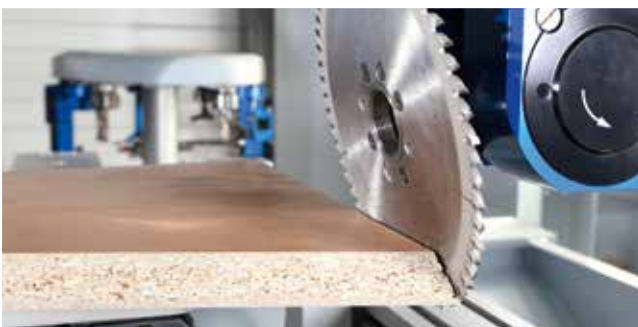
Sciage des découpes d'onglets
