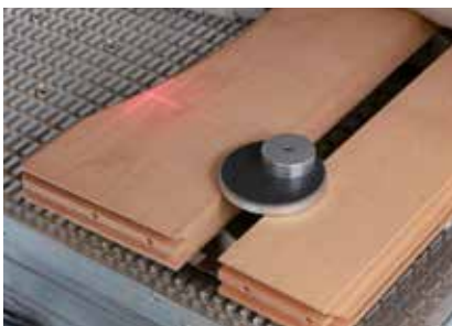
Laser di posizionamento per il posizionamento preciso delle ventose
