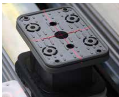
Aiuto di posizionamento con laser pin (opzione) la posizione delle ventose a depressione viene visualizzata con un puntatore laser. È inoltre possibile "percorrere" il contorno di pezzi liberi per facilitare il posizionamento.
