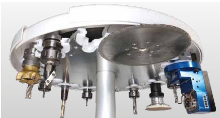
Magazzino circolare a 14 posizioni mobile in direzione X
