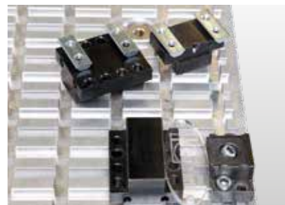
Tavolo a reticolo in alluminio con scanalature trapezoidali per il fissaggio e posizionamento preciso e flessibile di dispositivi di bloccaggio di tutti i tipi
