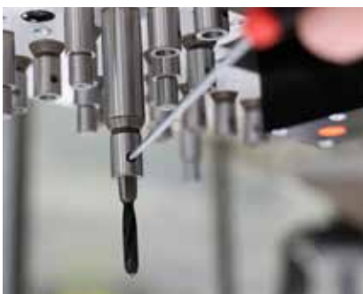
Sistema de cambio Weldon para un cambio de broca con herramientas
