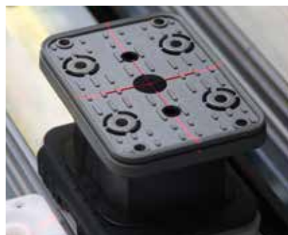
Ayuda de posicionamiento láser (opcional) Las ventosas de vacío se muestran con un láser de mira en cruz. Se puede "recorrer" el contorno de la pieza como ayuda de posicionamiento de la pieza de forma libre.
