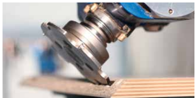
Fresado para los herrajes de unión
