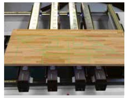
Proyección láser de los medios de fijación y del contorno de la pieza para un aprovechamiento óptimo y una colocación sencilla de las piezas en bruto que no se pueden alinear con los topes.
