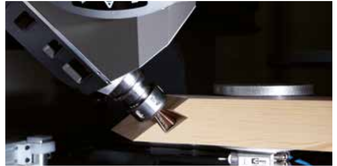
Fresado de un conjunto de rebabas para la construcción de postes y pasadores
