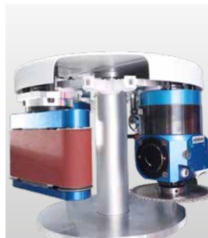
Cambiador circular de 8 posiciones en sentido X, de movimiento simultáneo
