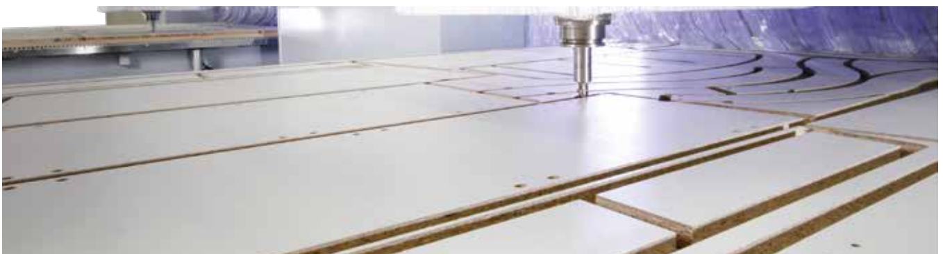
Mecanizado nesting de materiales para tableros: división y mecanizado con optimización del corte en la superficie
