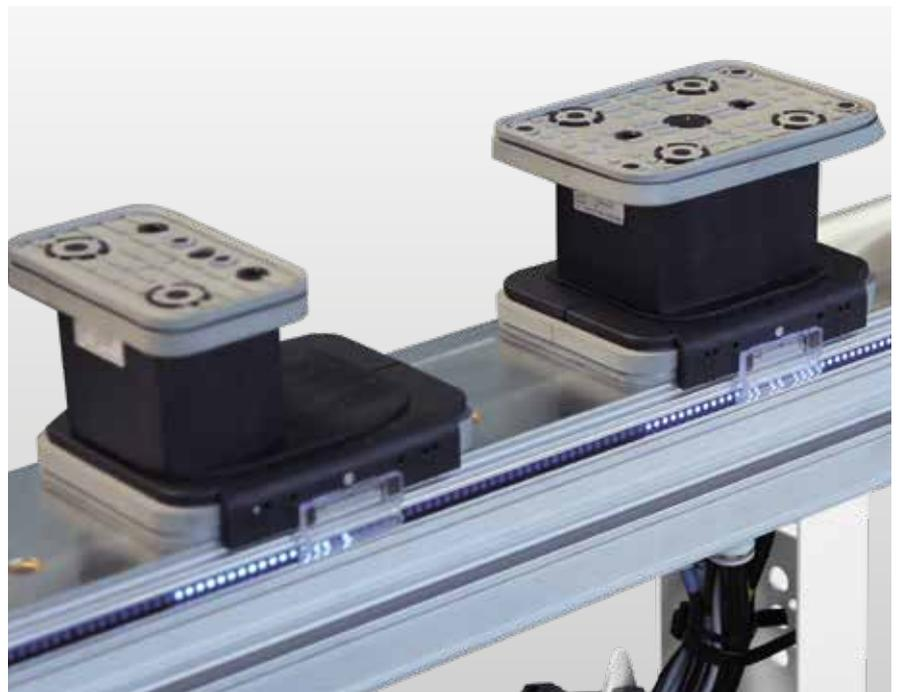
**LED-Positioniersystem (Option)** LED-Leuchten zeigen dem Bediener exakt die Position, die Ausrichtung und die Größe der Sauger sowie die Position der Konsolen an
