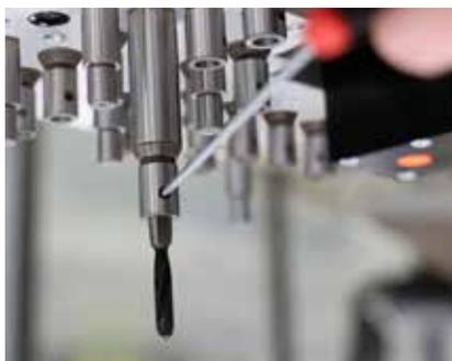
**Weldon Wechselsystem** für einen Bohrerwechsel mit Werkzeugen
