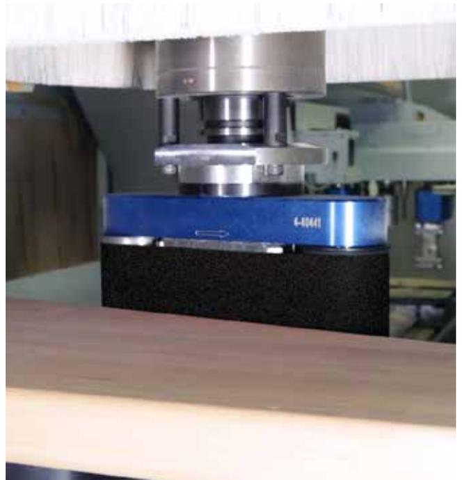
**Der smarte DRIVE5CS 5-Achs-Kopf** – kompakter gebaut mit kurzen Kraftwegen. Viel Technik auf kleinem Raum ohne Einschränkungen im Bearbeitungsspektrum. Flüssigkeitsgekühlte Spindeln mit 10 kW (optional 12 kW Frätleistung) für kraftvolles Arbeiten. Die kurze Bauform sorgt für mehr Platz zum Bearbeiten (z.B. auch mit einem 350 mm Sägeblatt, unter der Haube).
