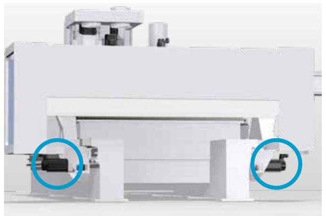
**Synchronantrieb** 2 synchronisierte digitale Servoantriebe in X-Richtung garantieren höchste Präzision
