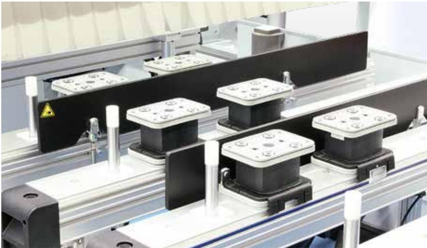
**Werkstückeinlegehilfen** Robuste Einlegehilfen zum Belegen schwerer Werkstücke mit 2 Pneumatikzylindern. Die lineare Bewegung der Einlegehilfen gewährleistet ein sicheres Anlegen der Werkstücke, egal, ob an den vorderen oder hinteren Anschlägen bearbeitet wird.
