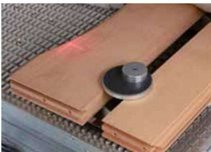
**Laserpositionierung** Die Fräskontur kann durch den Fadenkreuzlaser abgefahren werden
