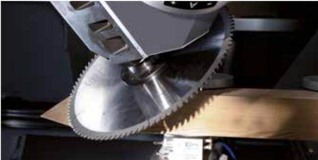
Schifterschnitt mit großer Schnitttiefe für Rahmenteile
