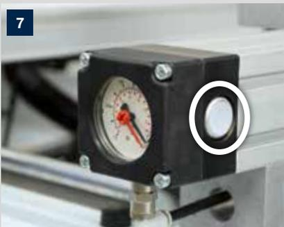
**Taster für den Programmstart** – Je ein Taster am linken und rechten Anschlagprofil dienen als Programmstart der Bearbeitung.
