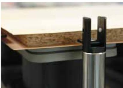
**Anschlagsystem (hinten, vorne und seitlich)** Massive Anschlagbolzen pneumatisch absenkbar inkl. elektronischer Endlagenabfrage
