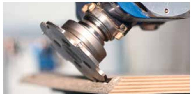
Ausfräsungen für Verbindungsbeschläge
