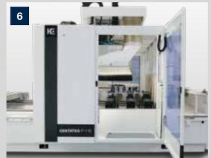
**Maximale Einsicht** in die Maschine und gleichzeitig optimaler Schutz des Bedieners durch großes Sichtfenster. Bohrerwechsel und Service können bequem von der Vorderseite der Maschine durchgeführt werden.
