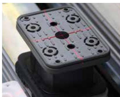
LASEROVÉ polohovacie pomôcky (voliteľné) vákuové prísavky sa zobrazujú laserovým krížovým zameriavačom. Obrys obrobku môže byť „obehnutý“ ako polohovacia pomôcka pre voľné časti.
