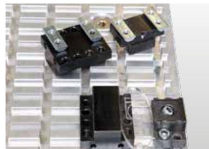
Hliníkový rastrový stôl s lichobežníkovými drážkami na tesné, flexibilné upevnenie upínacích prvkov všetkých druhov
