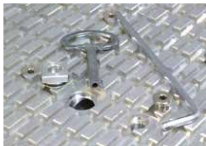
1" přípojky vakua s rychlým otvíráním pomocí klíče skříňového rozváděče, otvory vakuového systému s přesným závitem k upevnění upínacích prostředků
