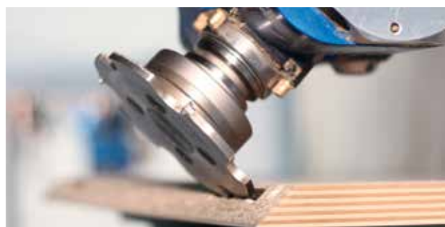
Vyfrézování otvoru pro spojovací kování
