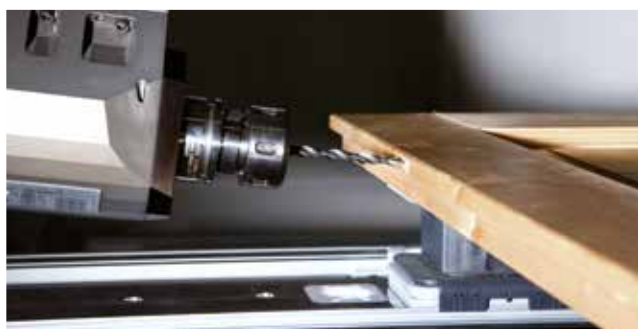
Vrtání pod úhlem
