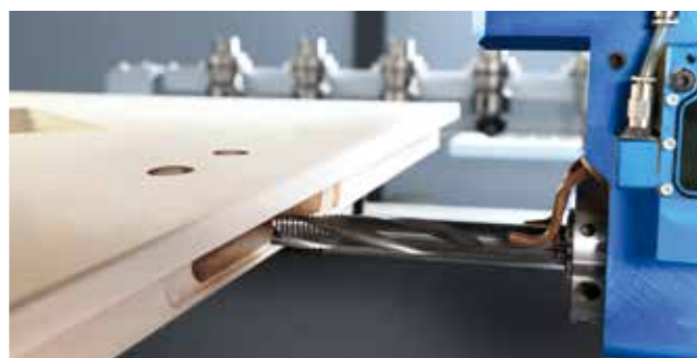
Vyfrézování dveřního zámku
