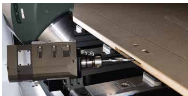
Frézování dveřního zámku
