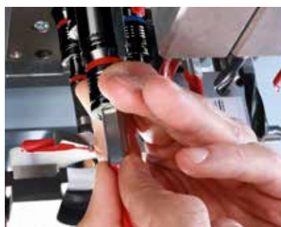
Opatentowany system szybkiej wymiany wiertel bez użycia narzędzi w celu skrócenia czasu przezbrajania
