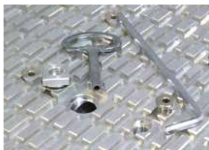
Przyłącza próżniowe 1" z mechanizmem szybkiego otwierania za pomocą klucza do szafy sterowniczej, otwory próżniowe z gwintem drobnozwojnym do montażu elementów mocujących
