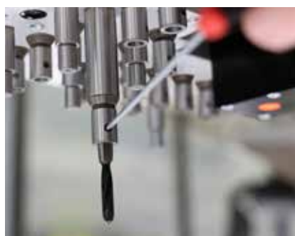
System wymiany Weldon do wymiany wiertel przy użyciu narzędzi
