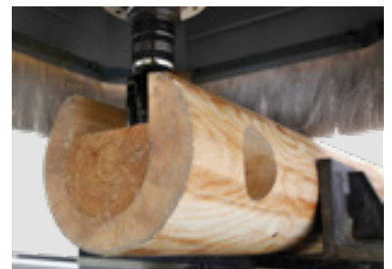
Bloc de serrage : bloc de serrage adapté aux éléments de rondins.
