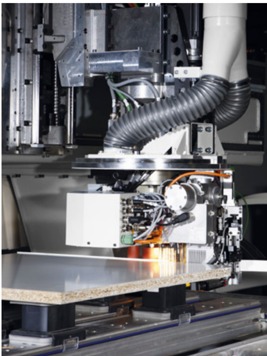
Placage laserTec pour des pièces de forme au jointage optimal
