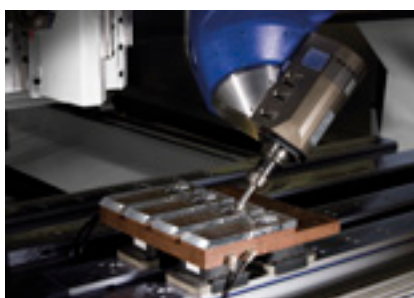
Fraisage grand brillant de pièces en acrylique
