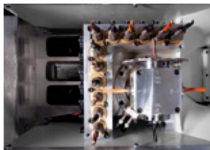
Tête de perçage V12/H4 : tête de perçage HIGH-SPEED 7 500 t/min. avec 12 broches verticales, une scie à rainurer et 4 broches horizontales pivotantes 0/90°. Perçage rapide, rainurage en X/Y compris.
