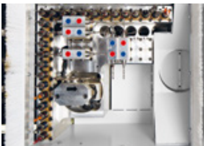
Tête de perçage V25/H10 : tête de perçage HIGH-SPEED allant jusqu'à 7 500 t/min. avec 25 broches verticales, 6 broches horizontales en X et 4 en Y avec rainurage en X.
