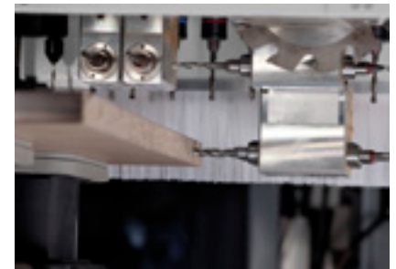
Perçages horizontaux pour assemblages de corps de meubles
