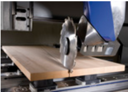
Coupes de séparation d'une hauteur allant jusqu'à 110 mm
