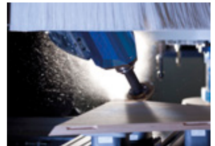
Fraisage de rainures en biais pour un assemblage de panneaux
