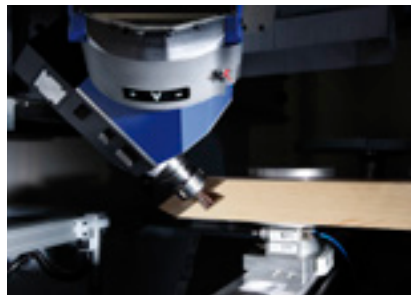
Fraisage assemblage biais pour poteaux/montants
