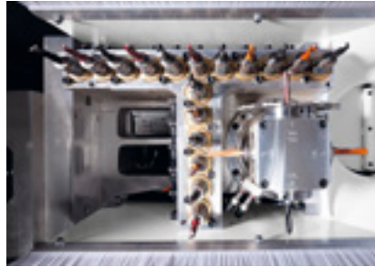
Tête de perçage V17/H4 : tête de perçage HIGH-SPEED allant jusqu'à 7 500 t/min. avec 17 broches verticales, une scie à rainurer et 4 broches horizontales pivotantes 0/90°. Moins de cycles de perçage, rainurage en X/Y compris.
