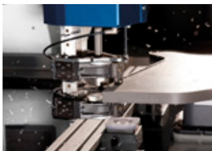
Chants d'une finition parfaite par agrégat palpé combiné our l'affleurage et le raclage
