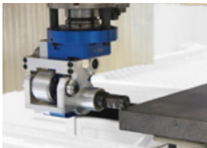
Affleurage au ras palpé des dépassements de chants de profil postformé
