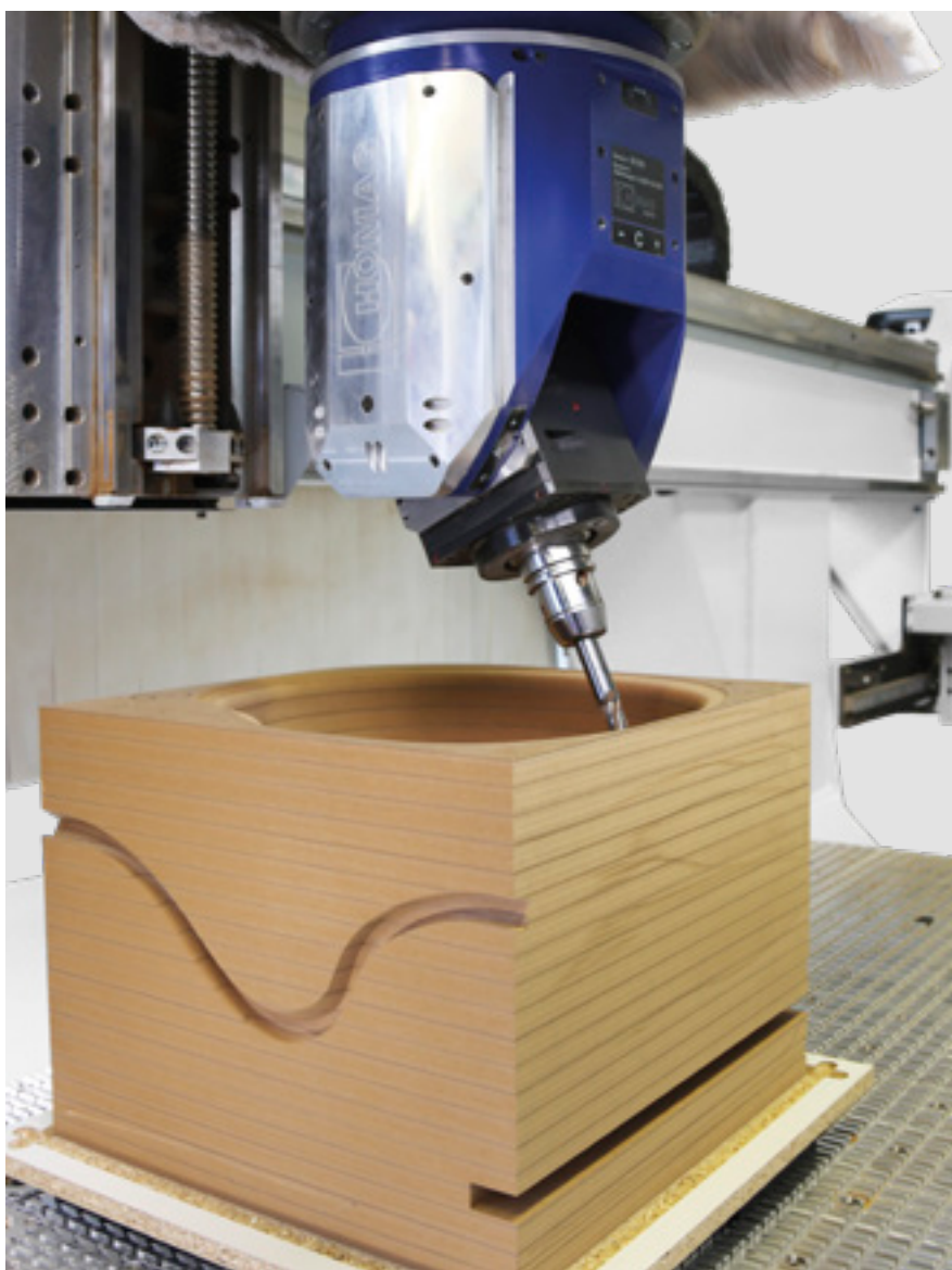
Fraisage de pièces ayant une grande hauteur Z
