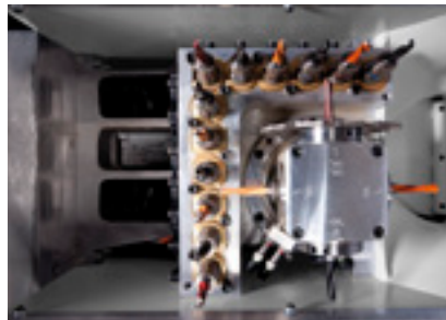
Testa a forare V12/H4: testa a forare HIGH-SPEED da 7500 giri/min con 12 mandrini verticali, lama a scanalare e 4 mandrini orizzontali girevoli da 0 a 90°. Foratura veloce, scanalatura in direzione X/Y compresa.
