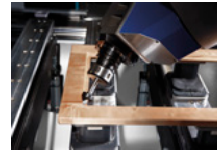
Fresata ad angolo retto su uno spigolo per la battuta del vetro
