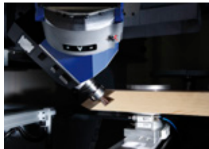
Fresatura di giunzioni tra montanti e traverse
