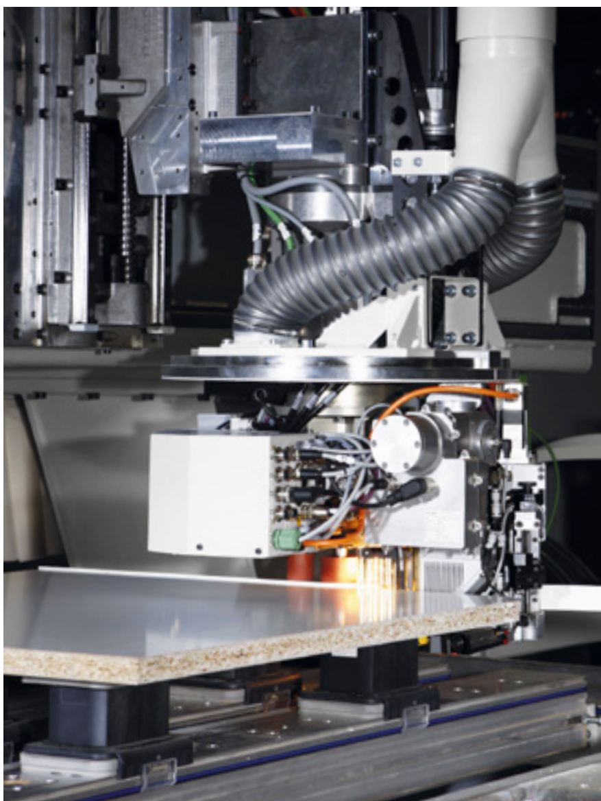
laserTec : bordatura di pezzi sagomati con giunzione a "0"
