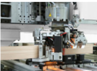
Bordatura per pezzi con un'altezza fino a 100mm
