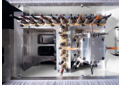
Testa a forare V17/H4: testa a forare HIGH-SPEED da 7500 giri/min con 17 mandrini verticali, lama a scanalare e 4 mandrini orizzontali girevoli da 0 a 90°. Meno cicli di foratura, scanalatura in direzione X/Y compresa.
