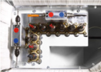
Testa a forare V9/H4: testa a forare HIGH-SPEED da 7500 giri/min con 9 mandrini verticali e 4 mandrini orizzontali.
