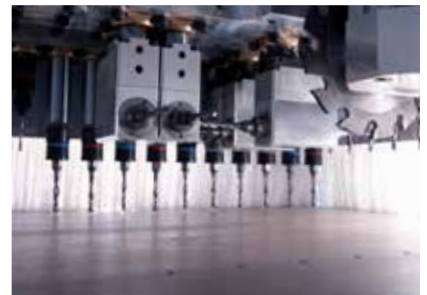
High-Speed-Bohrtechnik mit Nutsäge
