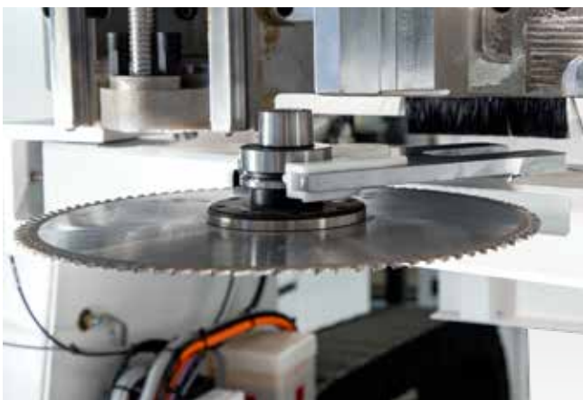
Ein zusätzlicher Pick-Up-Platz für Sägeblätter bis zu einem Durchmesser von 350 mm spart Plätze im Werkzeugwechsler. Frei mit anderen Werkzeugwechselsystemen kombinierbar.
