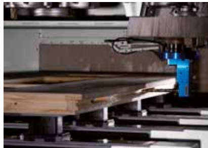
Schlosskastenfräsen an Haustüren
