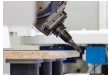
Getastetes Bündigräsen der Kantenüberstände am Postformingprofil
