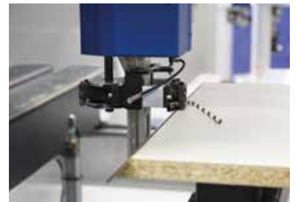
Ziehklingenbearbeitung an Gehrungskante
