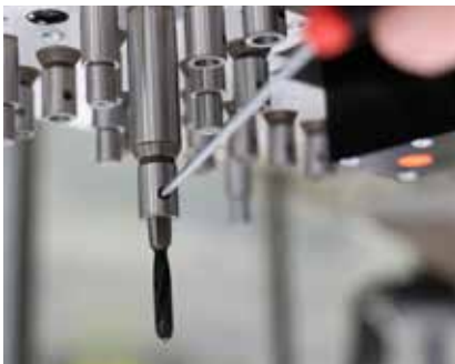
Weldon Wechselsystem für einen Bohrerwechsel mit Werkzeugen
