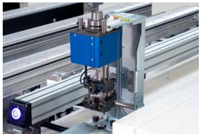
Der Werkzeugübergabeplatz ermöglicht eine komfortable Bestückung der Werkzeugwechsler und vermeidet Fehler.
