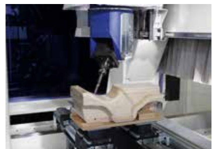
Interpolierende Bearbeitung von Freiformteilen
