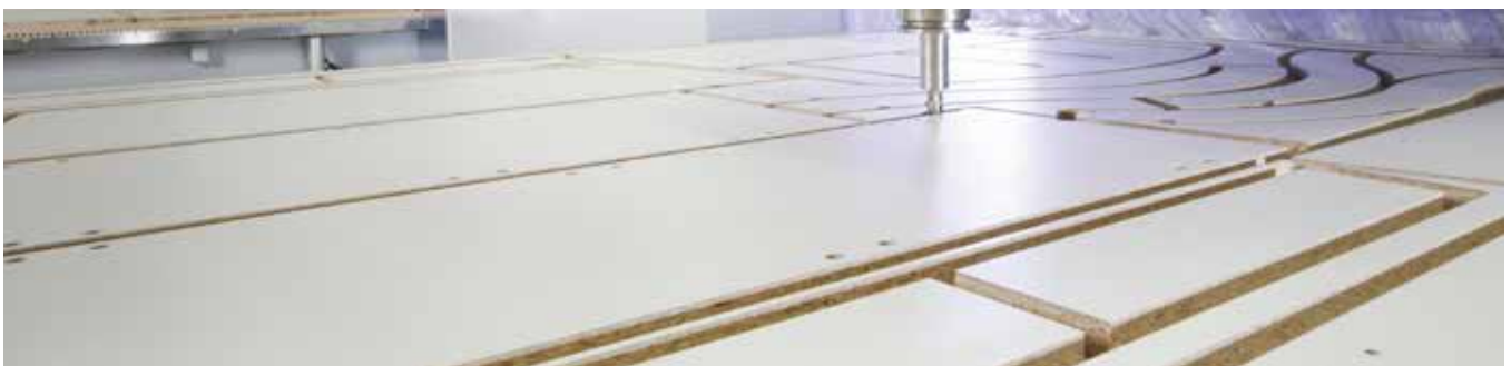
Nesting-Bearbeitung von Plattenwerkstoffen: Verschnittoptimiertes Aufteilen und Bearbeiten in der Fläche
