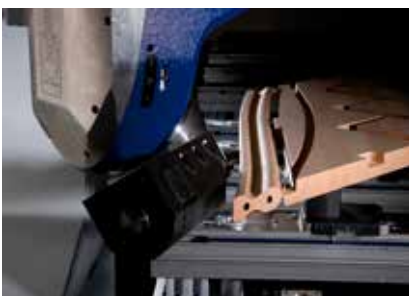
Staketenbohrungen in engem Winkel
