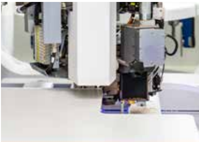
360° Kantenverleimung mit dem powerEdge Pro Duo Kantenanleimaggregat
