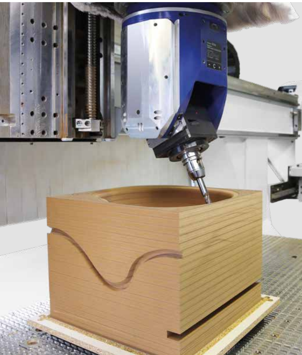
Fräsbearbeitung von Bauteilen mit großer Z- Höhe
