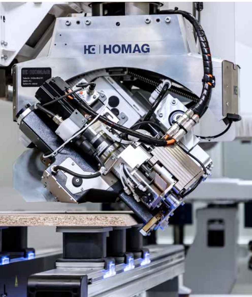
Chamfered edge gluing
