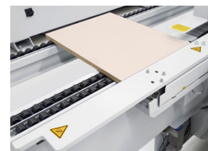
Automatyczne przestawianie liniału na wejściu do maszyny
