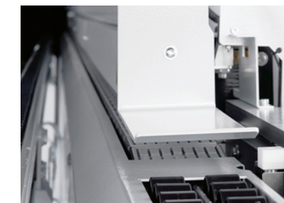
Blokada na wejściu do maszyny Zapewnia minimalny odstęp między elementami, gwarantując bezpieczną obsługę.
