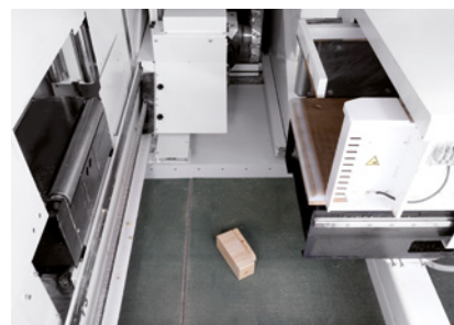
Späntransportband bereits in der Grundausstattung enthalten
