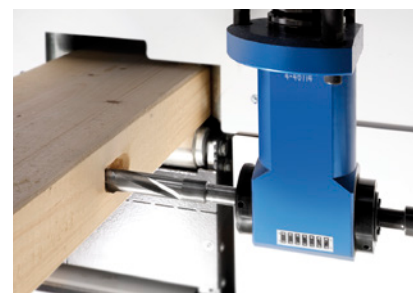
Wykonywanie otworów na czopy i kieszenie
