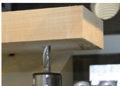
Frezowanie gniazd za pomocą agregatu do obróbki od spodu
