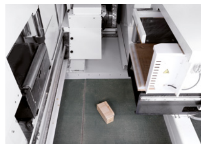
Dopravný pás na triesky je už súčasťou základného vybavenia
