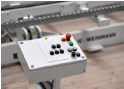
Panel de control local con sistema de control completo.
