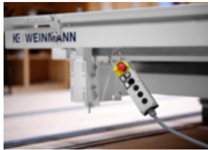
Mando de control (montado de forma flexible en la mesa) El control está integrado en la mesa.
