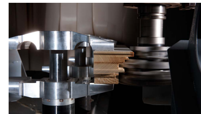
Flüssigkeitsgekühlte Frässpindeln mit Vektorregelung
