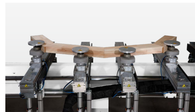
Bearbeitung von Bogenelementen, Türen und Flächenteilen
