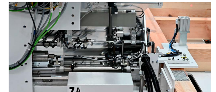
Schraubaggregat zum Verschrauben von Riegelwerken.
