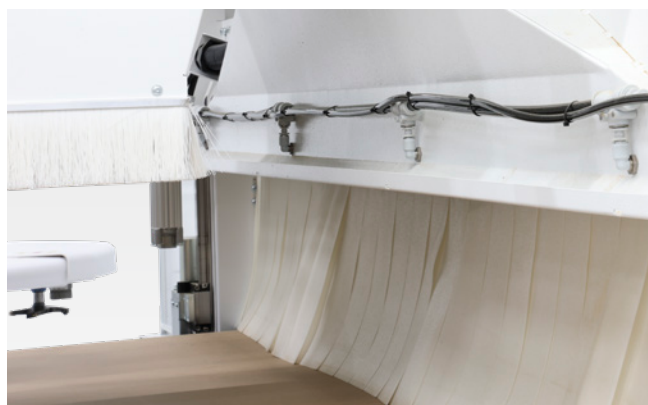
Kombinované odsávacie a vysúšacie zariadenie
