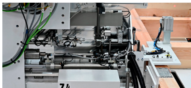
Skrutkovací agregát na skrutkovanie priečkových konštrukcií.
