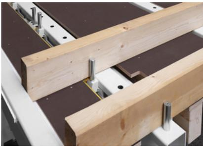
Les dispositifs de serrage de toit-plafond facilitent l'insertion et la fixation des arbalétriers et des poutres de plafond.
