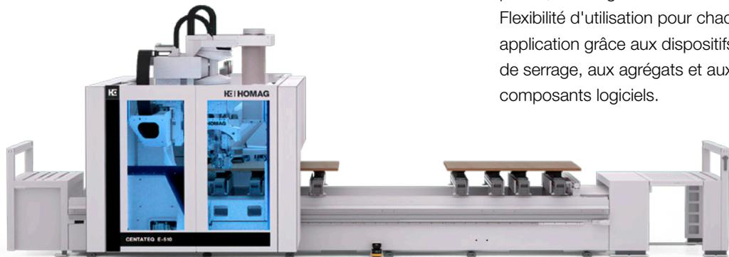
**CENTATEQ S-900** Destinée à la fabrication automatisée de fenêtres, cette gamme se compose de solutions d'entrée de gamme, mais aussi d'installations personnalisées pour un fonctionnement industriel multi-équipes. La table à console supplémentaire permet l'usinage de pièces courbes et de pièces planes.
