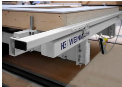
Alignement selon un angle déterminé des éléments sur la butée en X.
