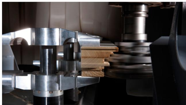
Broches de fraisage à refroidissement liquide avec régulation vectorielle
