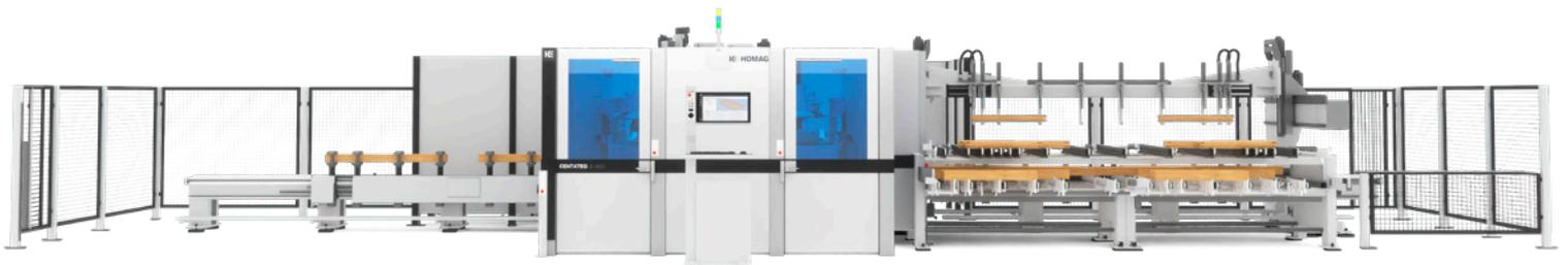
**Nesting** : l'usinage des éléments de panneaux sur un panneau martyr permet de diviser et d'usiner verticalement en une seule étape. Idéal pour les panneaux de façade, les revêtements et les panneaux isolants dans une grande variété de modèles.
