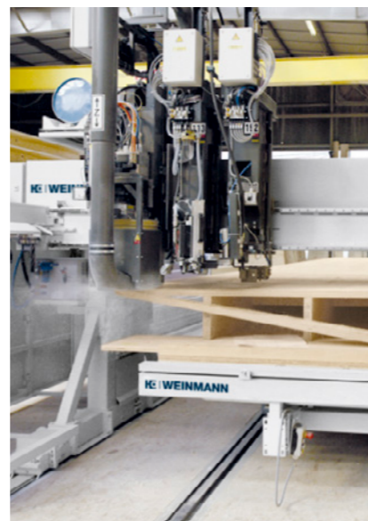
Полностью автоматическая распиловка
