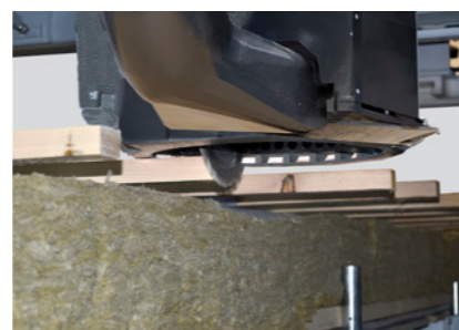
Форматирование обрешетки стропильных элементов
