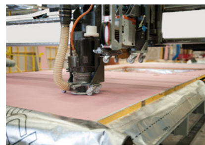
Obróbka płyt kartonowo-gipsowych
