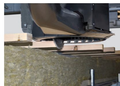
Façonnage des lattes de toit
