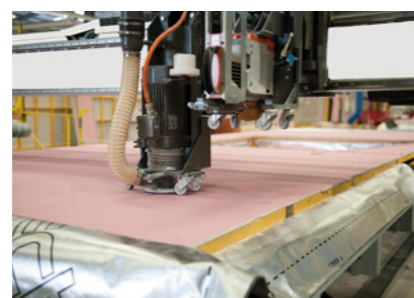
Usinage de placoplâtre
