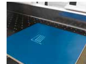
Mit diesem Symbol gekennzeichnete Teile legt der Bediener direkt ins Handrestelager.
